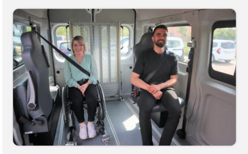
Entièrement aménagé pour le transport de personnes à mobilité réduite, le Nissan Interstar L3H2 peut accueillir de 1 à 5 fauteuils roulants ou encore offrir 9 places assises. Il est équipé d'une rampe d'accès arrière et de systèmes d'ancrage sécurisés pour les fauteuils roulants, garantissant une installation rapide et sécurisée.
